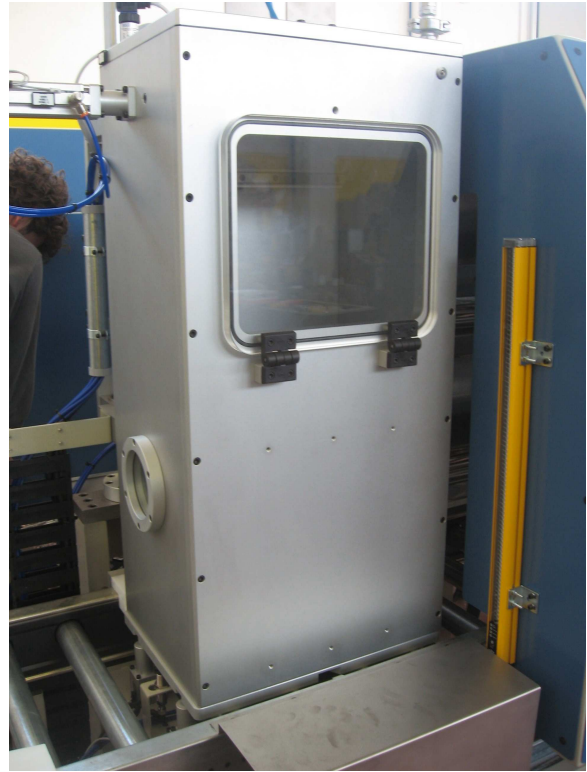
Linea automatica con cabina del vuoto provvista di sistema X-Y. Produzione oraria 60 motori/ora.
