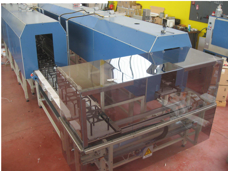
Linea per inglobamento motori in resina epossidica, con colata sotto vuoto. Produzione 50 motori/ora.
